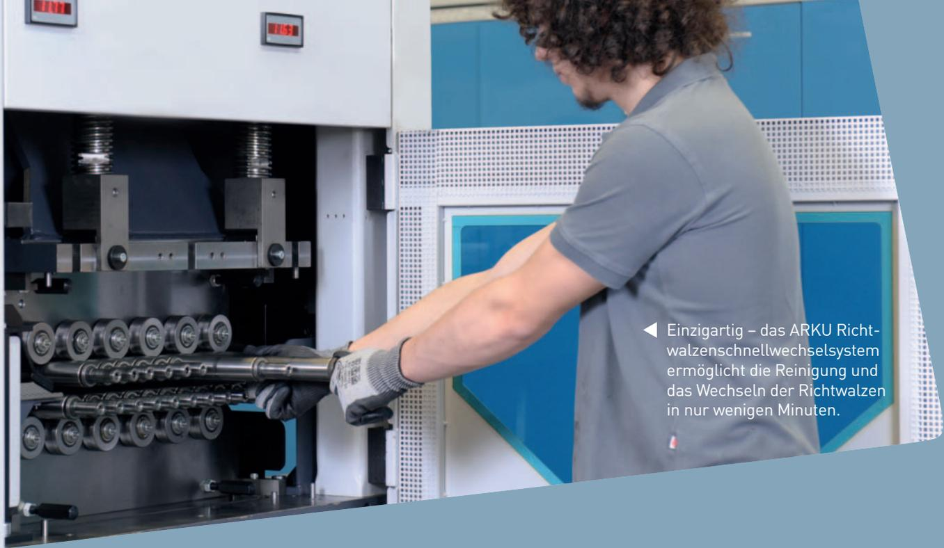
◀ Einzigartig – das ARKU Richtwalzenschnellwechselsystem ermöglicht die Reinigung und das Wechseln der Richtwalzen in nur wenigen Minuten.
